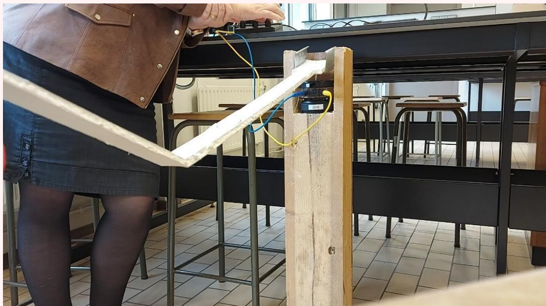
Bij de resonantiefrequentie is de trilling van de brug maximaal op de plaats waar de buik zich bevindt. Als de amplitude voldoende is, breekt het.
