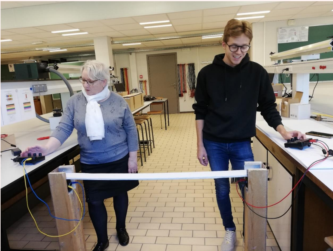
Foto van het apparaat. De gipsplaat wordt ondersteund door twee metalen inkepingen die elk aan de oscillatoren zijn bevestigd. Elke oscillator is verbonden met een frequentiegenerator.
