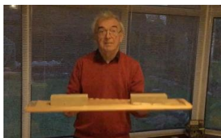
Figuur 1 De plank met blokken en elastiek klaar om naar boven te worden gegooid
