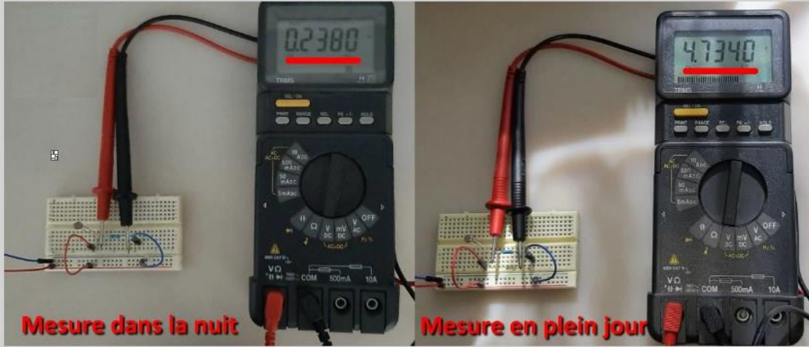
Mesure de la tension sur pont diviseur de tension
