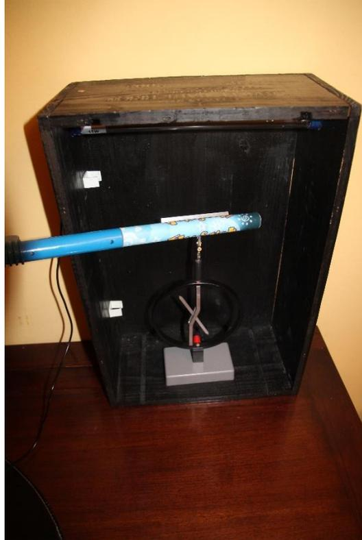
Ensuite, on approche les UV de la plaque, dans l'ordre UVA, UVB et UVC. Lors de l'approche de ces derniers, l'aiguille revient à son point de départ ; les photons ont « arraché » les électrons
