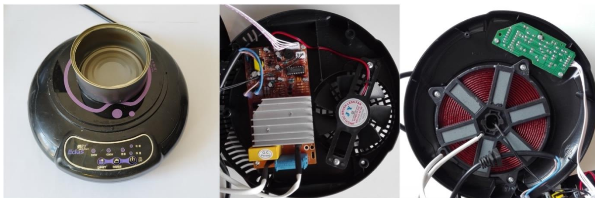
Figuur 9: Inductiekookplaat en de interne onderdelen ervan – circuitplaat en spoel
