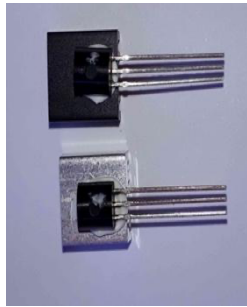
Fig. 2a: Capteurs avec dissipateur thermique. Fig. 2b: Capteur prêt à l'emploi avec batteries.
