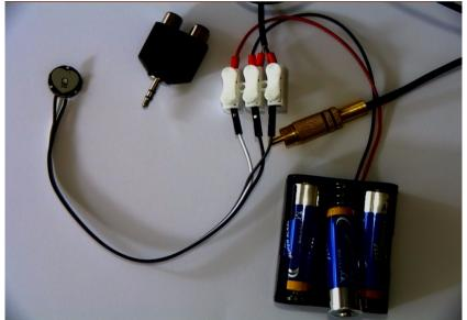
Pour la connexion aux oscilloscopes, une fiche RCA est connectée à un câble blindé; le blindage est connecté à la terre, la ligne "chaude" à la sortie du signal. Avec les adaptateurs appropriés, par exemple prise RCA vers fiche BNC (pour oscilloscopes) ou 2 prises RCA vers entrée microphone (pour oscilloscope carte son), le signal de l'onde de pouls généré par le flux sanguin dans les vaisseaux artériels périphériques peut être mis en évidence.
