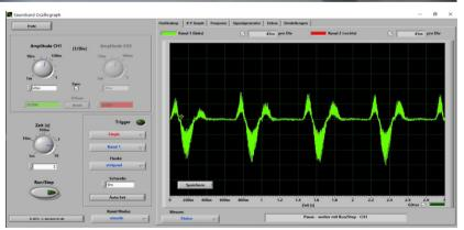
Affichage du signal d'impulsion au moyen d'un oscilloscope à carte son.
